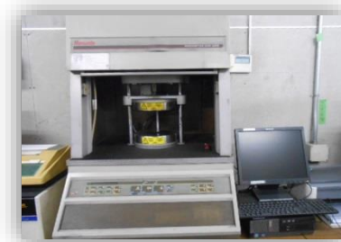
RHEOメーター(ODR) (加硫曲線をデータ化で表す)
